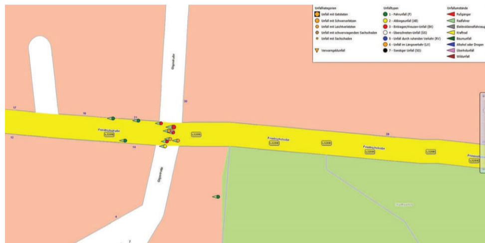
Die Unfalltypensteckkarte der Kreuzung Friedrichstraße / Olgastraße in Friedrichshafen zeigt Unfälle mit Beteiligung von Radfahrern im Zeitraum 01.01.2022 bis 01.12.2024. Im Mai 2023 wurde der provisorische Kreisverkehr in Betrieb genommen, seither ergab sich nach Aussage der Polizei eine Häufung von Unfällen. (pol)
