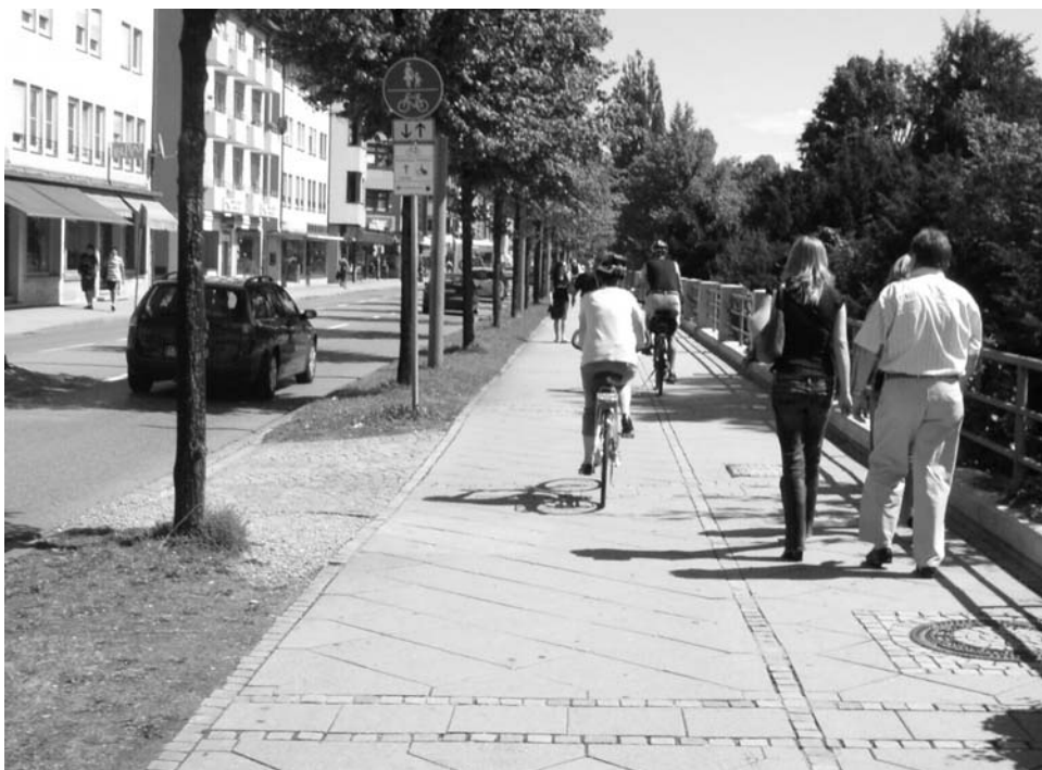
An der Friedrichstraße besteht ein gemeinsamer Geh- / Radweg. Dennoch suggeriert die Pflasterzeile noch immer eine Trennung zwischen Geh- und Radweg. Noch Fragen?
