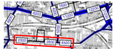
Ohne Durchfahrtsmöglichkeit für den Kfz-Verkehr verbleiben laut Prognose 2.000 bis 4.500 Kfz/24 h, bestehend aus Nutzern des Parkhauses am See und des Bahnhofs, aus Anliegern und dem ÖV. Diese Kfz-Belastung ist mit Radverkehr im Mischverkehr auf der Fahrbahn gut verträglich.
