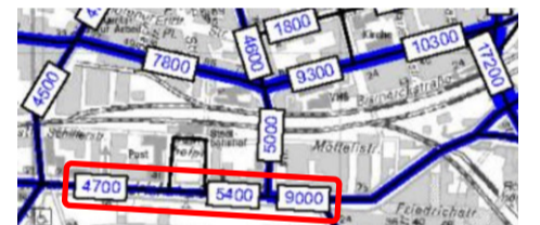
Die Prognose mit B 31 neu ergab bei weiterhin uneingeschränkter Durchfahrtsmöglichkeit der Friedrichstraße für den Kfz-Verkehr eine Belastung von 4.700 bis 9.000 Kfz/24 h.
