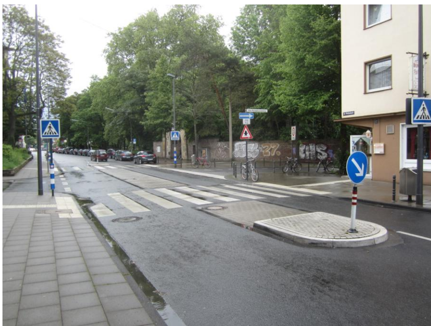
Abbildung 3-5: Geteilte Überquerungshilfe innerorts (Beispiel aus Köln)
