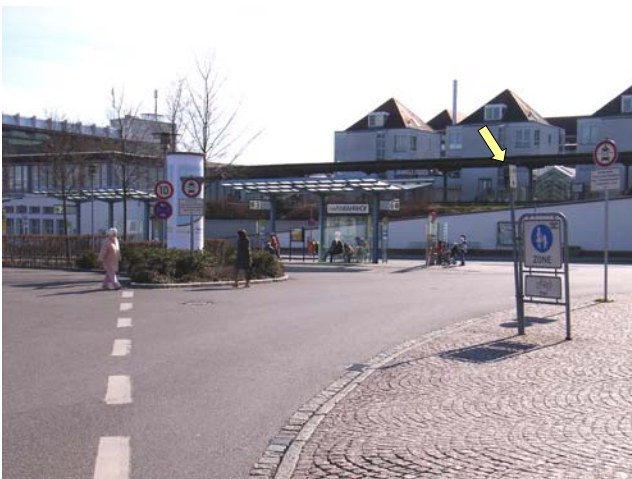
Bild 3 * Romanshorner Platz, Zufahrt Busbahnhof Der Wegweiser Richtung Innenstadt ist zu klein, liegt nicht in der Sichtachse und ist seit Monaten verdreht. Vorschlag : Ein Pfeilwegweiser an der Stelle des Schildes „10 km/h“.
