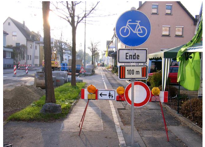
Bild 42: Paulinenstraße, 2005: Das Radweg-Ende wird in 100 m angekündigt, doch das Fahrverbot (Zeichen 250) gilt ab sofort. Eine unlogische Beschilderung
